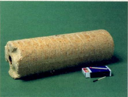
Bild 23: Holzbrikett aus bindemittelfrei verpressten Spänen.
