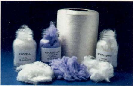
Bild 22: Moderne Textilfasern aus Cellulose.
