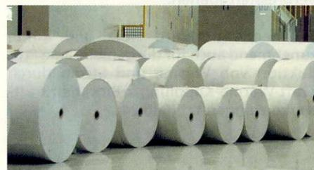
Bild 21: Rollenpapiere für Zeitungs- und Magazindruck.
